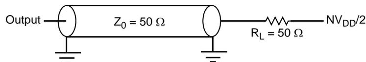
**Figure 46. I<sup>2</sup>C AC Test Load**
