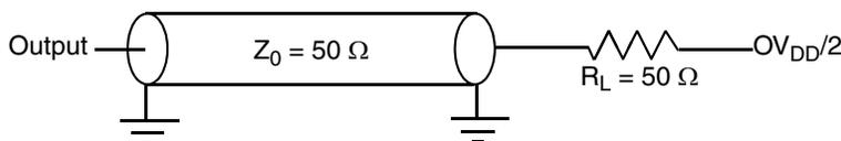
**Figure 30. I<sup>2</sup>C AC Test Load**
