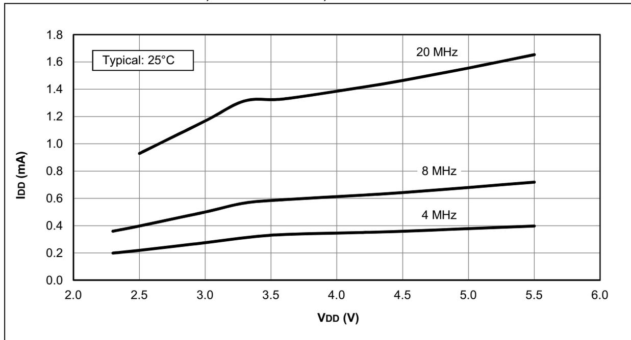
**FIGURE 30-30: I<sub>DD</sub> MAXIMUM, HS OSCILLATOR, PIC16F1508/9 ONLY**
