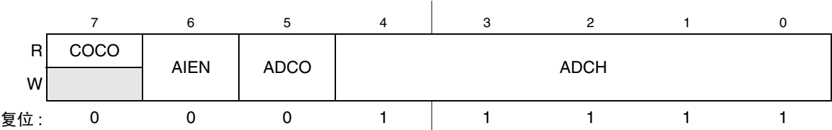
图 10-3. 状态和控制寄存器（ADCSC1）
