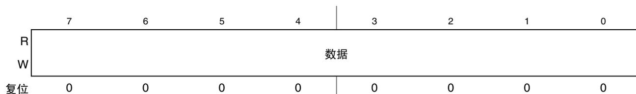
图 11-7. IIC 数据 I/O 寄存器 (IICD)
