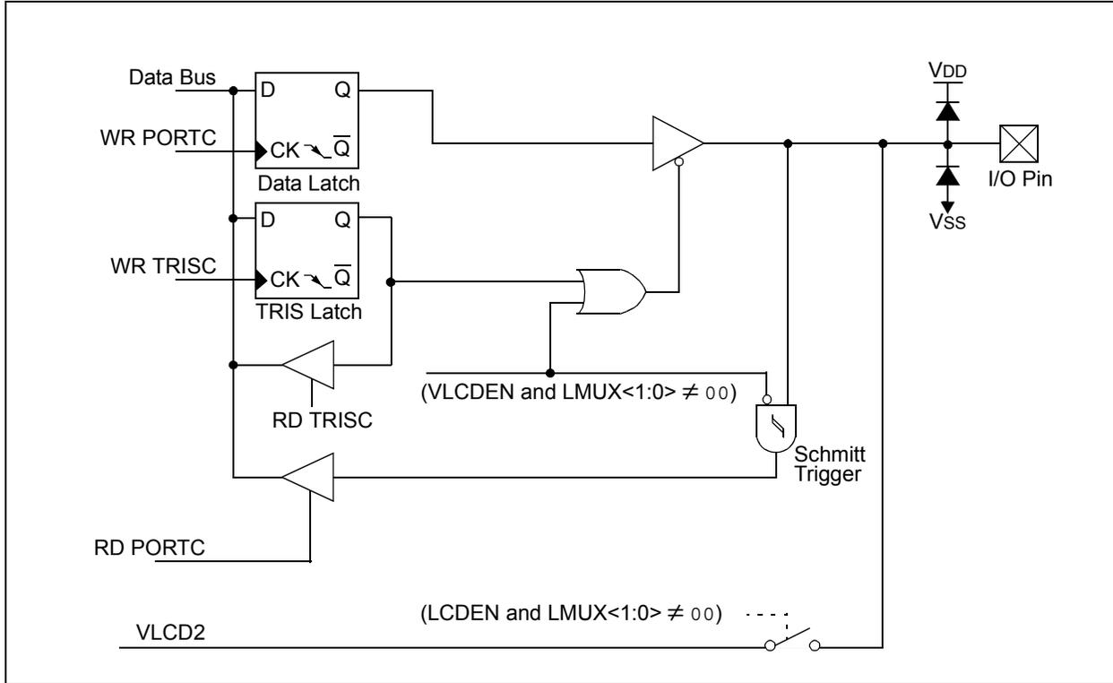
**FIGURE 3-16: BLOCK DIAGRAM OF RC2**
