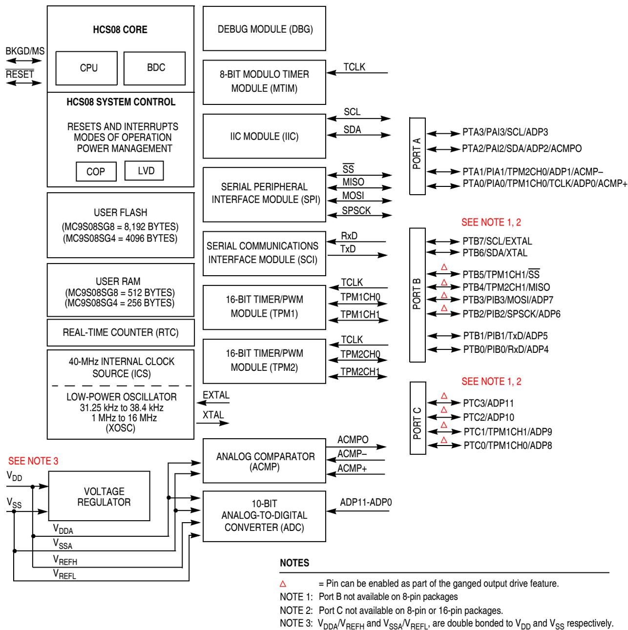
Figure 1-1. MC9S08SG8 Block Diagram
