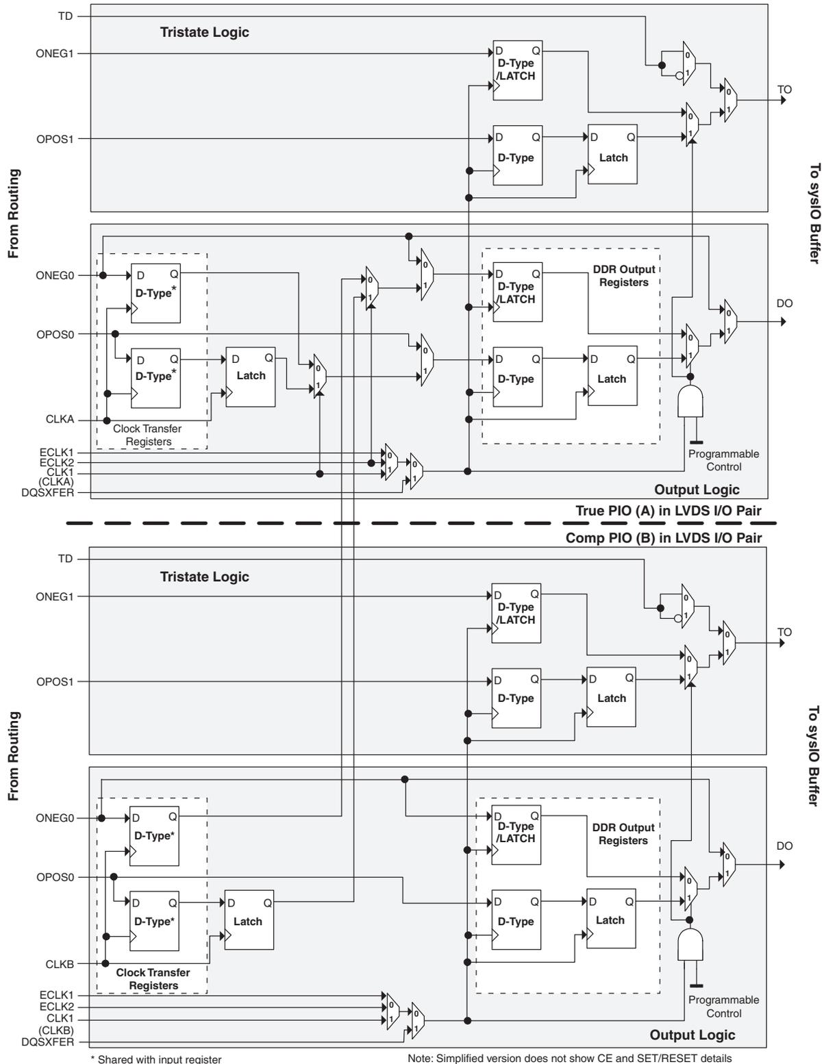
Figure 2-28. DQS Input Routing (Left and Right)
