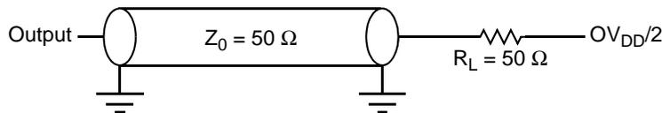
**Figure 40. I<sup>2</sup>C AC Test Load**
