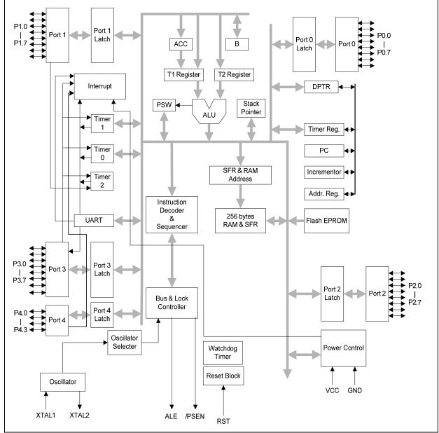
Figure 6- 1 W78I054D/W78I052D/W78I051D Block Diagram
