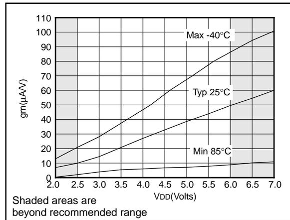
**FIGURE 21-21: TRANSCONDUCTANCE(g<sub>m</sub>) OF XT OSCILLATOR vs. V<sub>DD</sub>**
