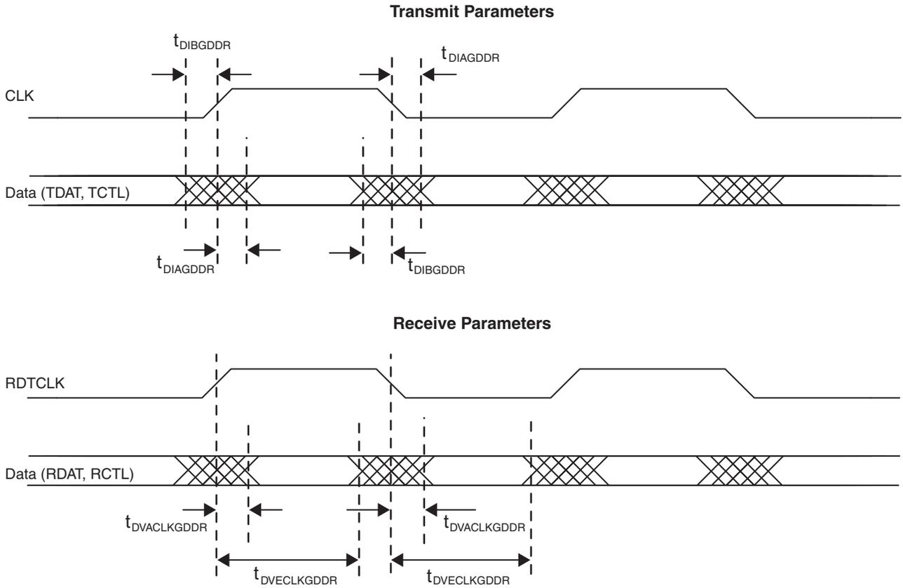
Figure 3-7. DDR/DDR2/DDR3 Parameters
