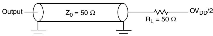
**Figure 23. I<sup>2</sup>C AC Test Load**
