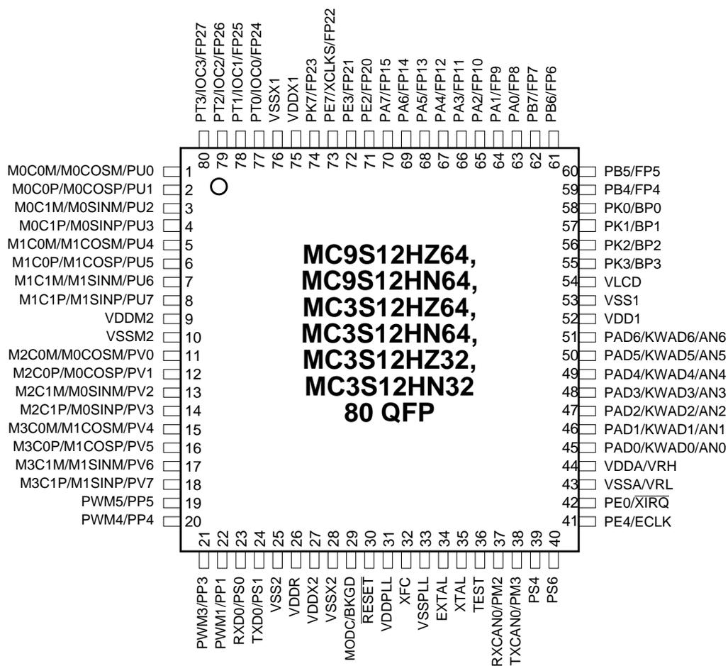
Figure 1-8. 80-Pin QFP for MC9S12HZ(N)64, MC3S12HZ(N)64 and MC3S12HZ(N)32
