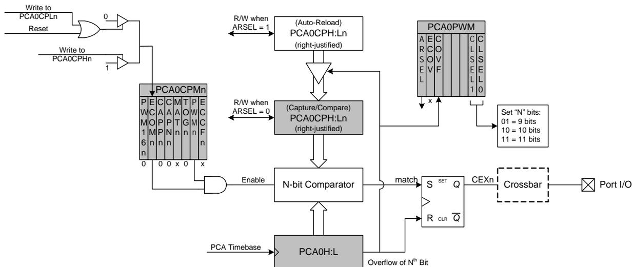
**Figure 34.9. PCA 9, 10 and 11-Bit PWM Mode Diagram**
