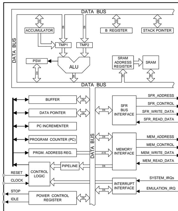
**Figure 16.1. CIP-51 Block Diagram**
