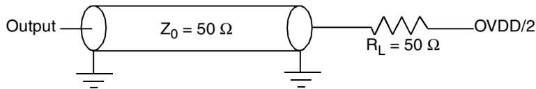
**Figure 37. I<sup>2</sup>C AC Test Load**
