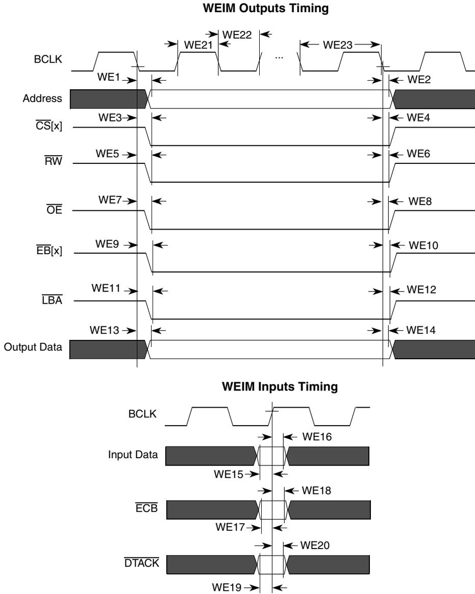
Figure 27. WEIM Bus Timing Diagram
