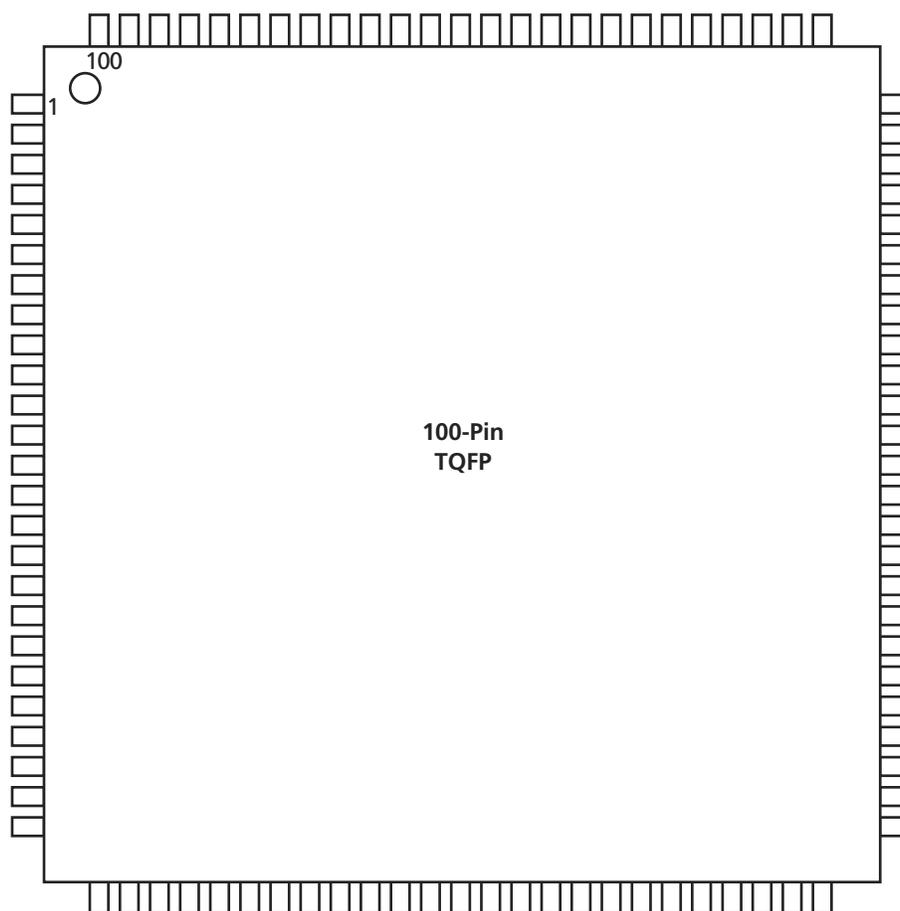
Figure 3-2 • 100-Pin TQFP
