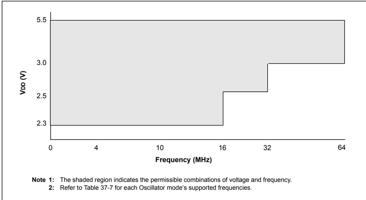
**FIGURE 37-2: VOLTAGE FREQUENCY GRAPH,  $-40^{\circ}\text{C} \leq T_A \leq +125^{\circ}\text{C}$ , PIC18LF27/47K40 ONLY**
