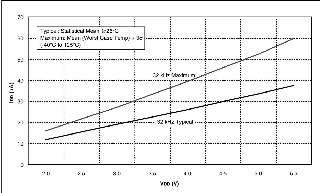
FIGURE 16-11: TYPICAL I<sub>DD</sub> vs. F<sub>osc</sub> OVER V<sub>DD</sub> (HFINTOSC MODE)
