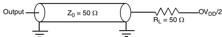
Figure 29. I<sup>2</sup>C AC Test Load
