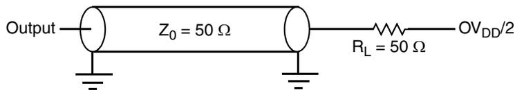
**Figure 49. I<sup>2</sup>C AC Test Load**
