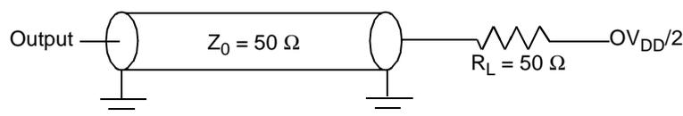
**Figure 16. I<sup>2</sup>C AC Test Load**
