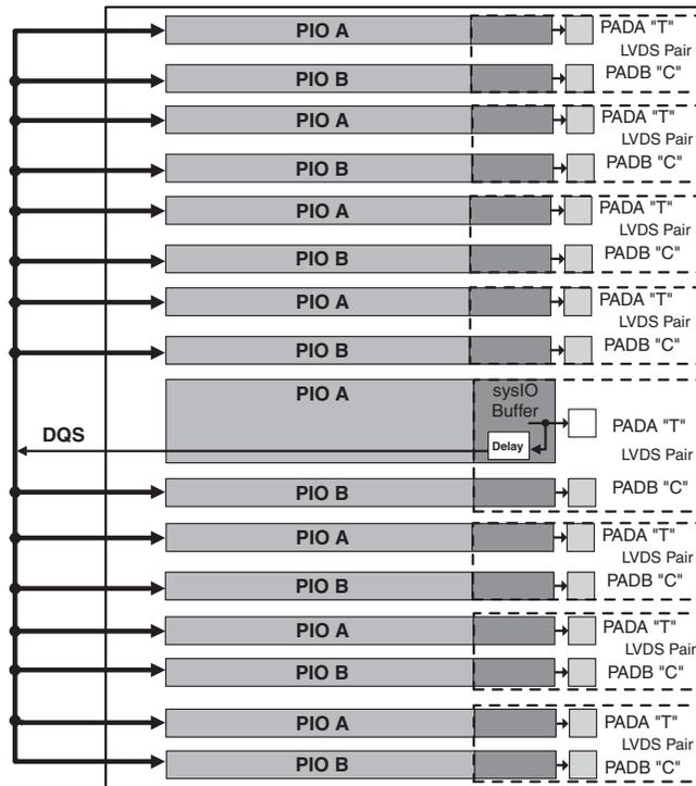
Figure 2-29. DQS Input Routing (Top and Bottom)
