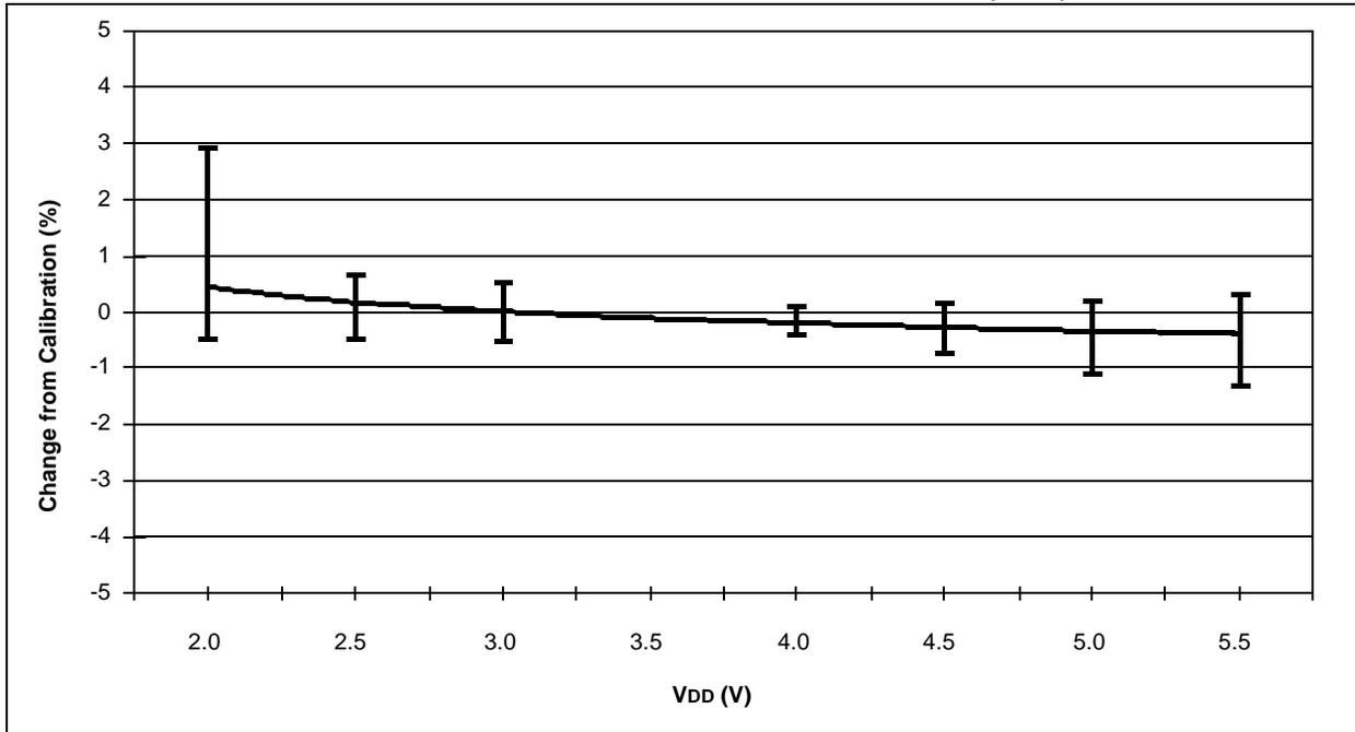
FIGURE 16-46: TYPICAL HFINTOSC FREQUENCY CHANGE vs. V<sub>DD</sub> (85°C)
