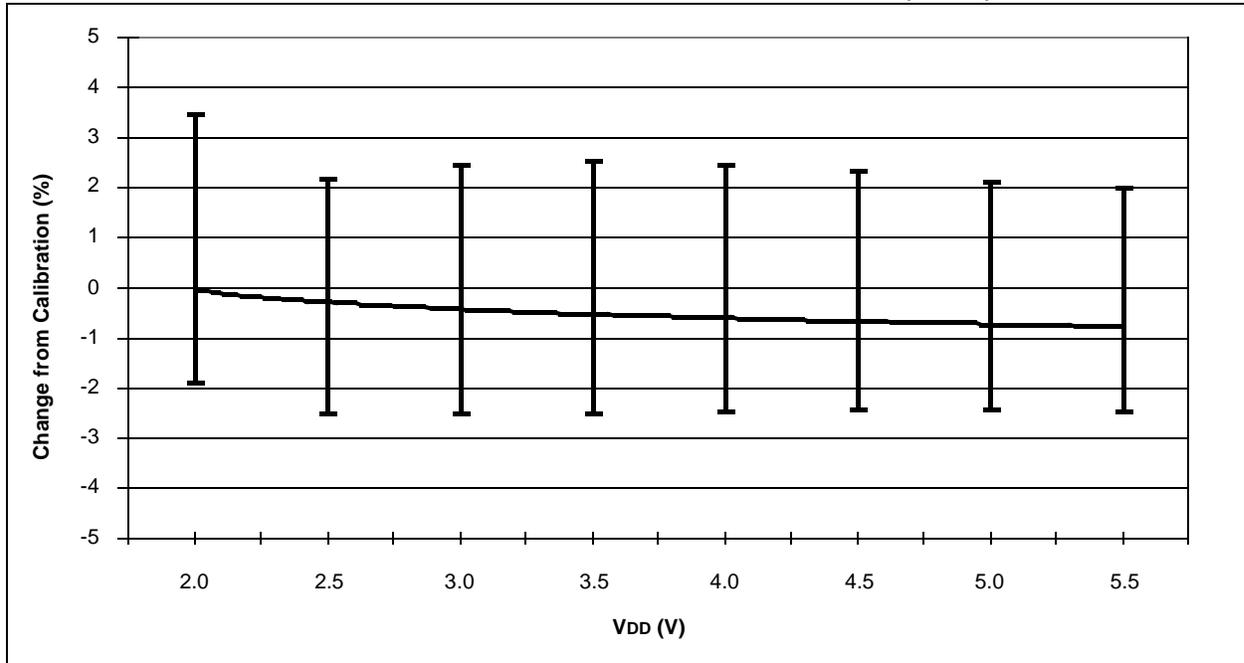
FIGURE 16-48: TYPICAL HFINTOSC FREQUENCY CHANGE vs. V<sub>DD</sub> (-40°C)
